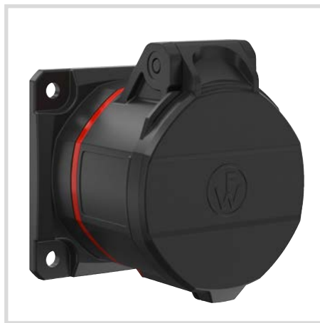
CEE NEO socles de tableau droit 5 x 16 A | 6h | IP54 avec raccordement par vis ou cages à ressort
