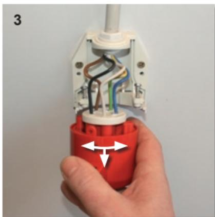
Démontage: desserrer les vis de fixation, puis faire pivoter la partie avant de gauche à droite tout en tirant vers le bas
