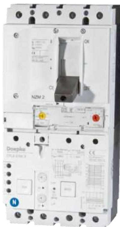
Les CBR (Circuit-Breakers with Integral Residual Current Protection = disjoncteurs avec protection intégrale contre les courants de défaut) sont des disjoncteurs de puissance qui disposent d'un déclencheur de surintensité magnétique et thermique et un déclencheur de courant de défaut.
