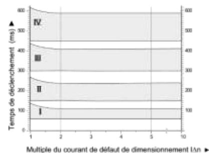
Durées d'arrêt totales des interrupteurs différentiels légèrement retardé et non retardé des types DFS 2 / 4 (à gauche) et CBR de la série DFL 8 (à droite)
