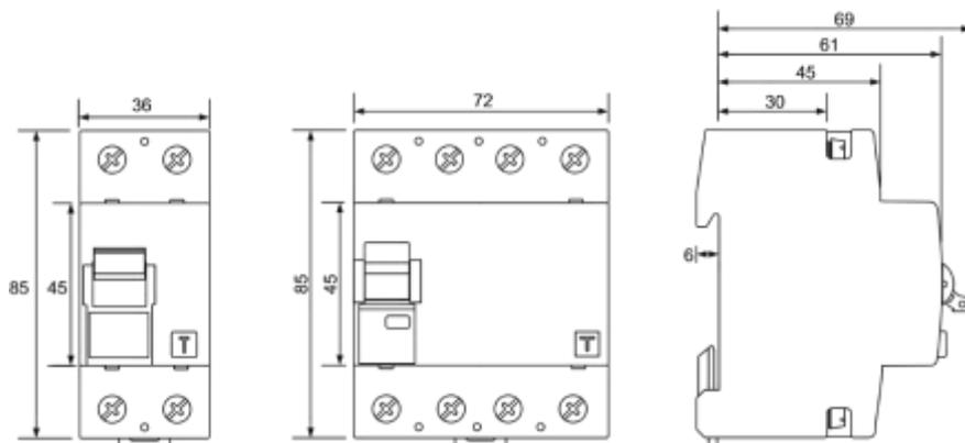
**Interrupteur différentiel (RCCB) • type A S • 2/4 pôles**
