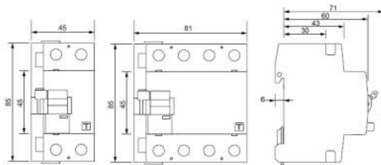
**Interrupteur différentiel (RCCB) • Type AC • 2/4 pôles**
