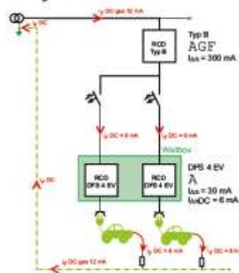
Si plusieurs chargeurs sont présents, un RCD de type B doit être monté en amont, car les courants de défaut CC peuvent s'accumuler en cas de panne. Un RCD en amont de type A ne peut plus remplir sa fonction protectrice.
