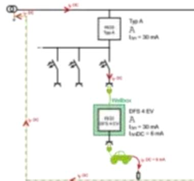
Lorsqu'un chargeur est exploité par une prise de courant, qui est protégée par un interrupteur RCD de type A, en cas de panne il est nécessaire de limiter les courants de défaut plats à 6 mA au maximum afin d'éviter le masquage du dispositif RCD en amont
