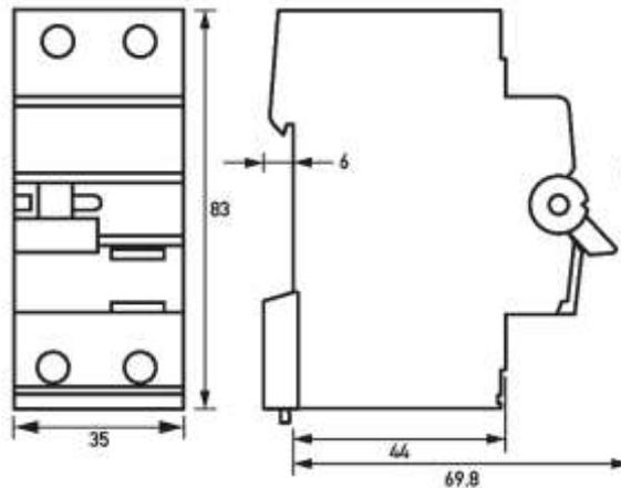
**Disjoncteur différentiel DRCBO 3 • 1P+N • A / AC**
