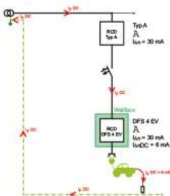
Pour se conformer aux durées d'arrêt du réseau TT, il est nécessaire de monter en série un RCD même si un chargeur installé en permanence est présent. L'aveuglement du RCD est empêché par la fonction protectrice de 6mA CC.
