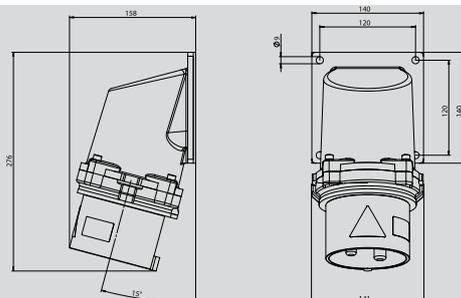
**CEE Socle de connecteur coudé courant fort avec connexion à vis**
