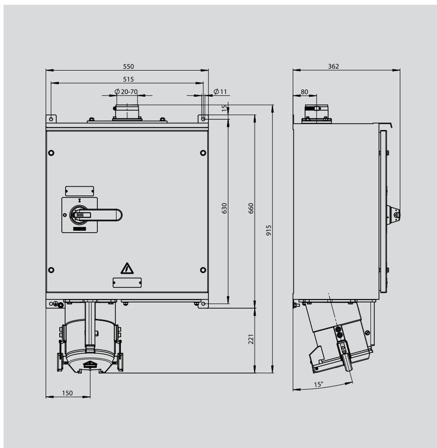
**CEE Prise murale interruptible courant fort** avec verrouillage mécanique avec interrupteur sectionneur 3 pôles contacts en laiton argenté, Boîtier en tôle d'acier revêtu par poudre, B-Line
