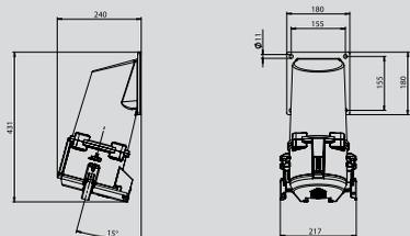
**CEE Socle de tableau coudé courant fort avec connexion à vis**
