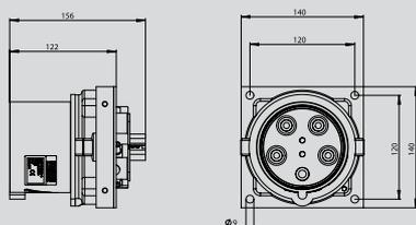
**CEE Socle de connecteur courant fort avec connexion à vis**
