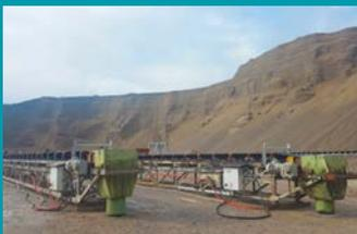
**Carrières** | Les prises de courant sont utilisées pour l'alimentation électrique des convoyeurs. IP 67 et IK 10 offrent une protection contre les contraintes et agressions extérieures.
