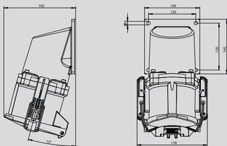
**CEE Socle de tableau coudé courant fort avec connexion à vis**
