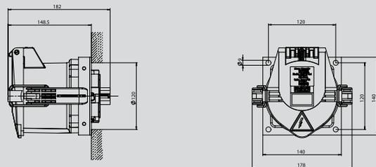
**CEE Socle de tableau droit courant fort avec connexion à vis**
