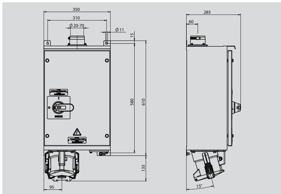
**CEE Prise murale interruptible courant fort** avec verrouillage mécanique avec interrupteur sectionneur 3 pôles contacts en laiton argenté, Boîtier en tôle d'acier revêtu par poudre, C-Line
