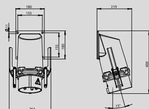
**CEE Socle de connecteur coudé courant fort avec connexion à vis**
